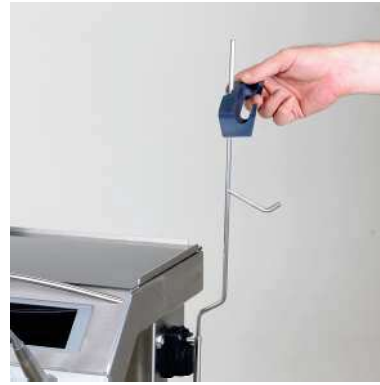
Ablage für Motor einhängen und fixieren.
